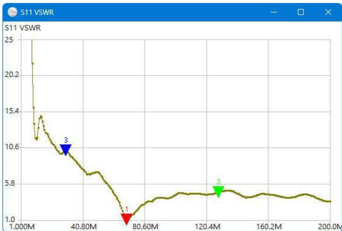
Рис. 38. График КСВ для полностью раскрытой телескопической антенны
