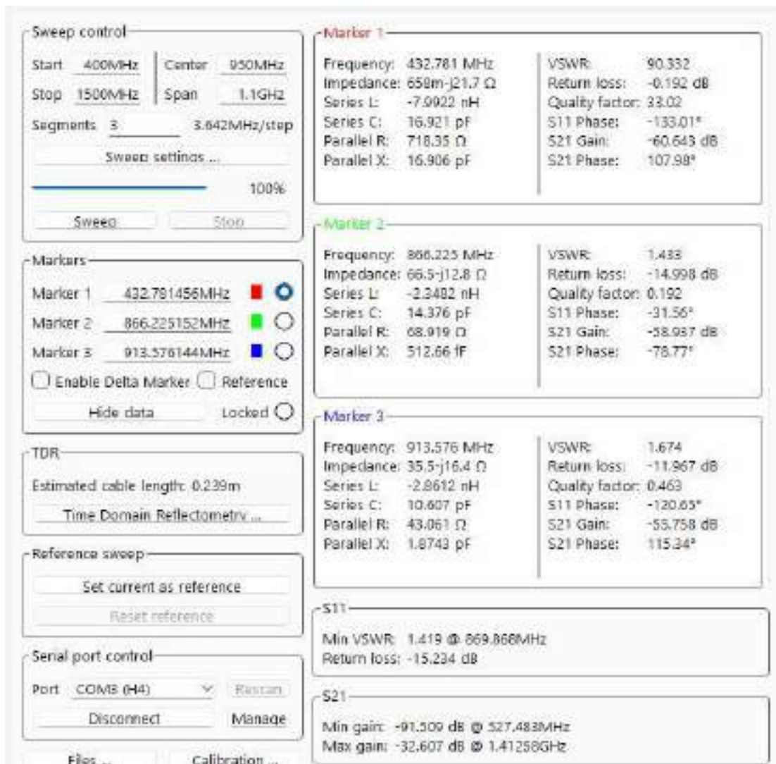
Рис. 37. Результаты измерений для антенны на 866 МГц
