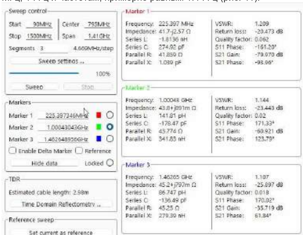
Рис. 41. Параметры штатной антенны приёмника RTL-SDR Blog V4
