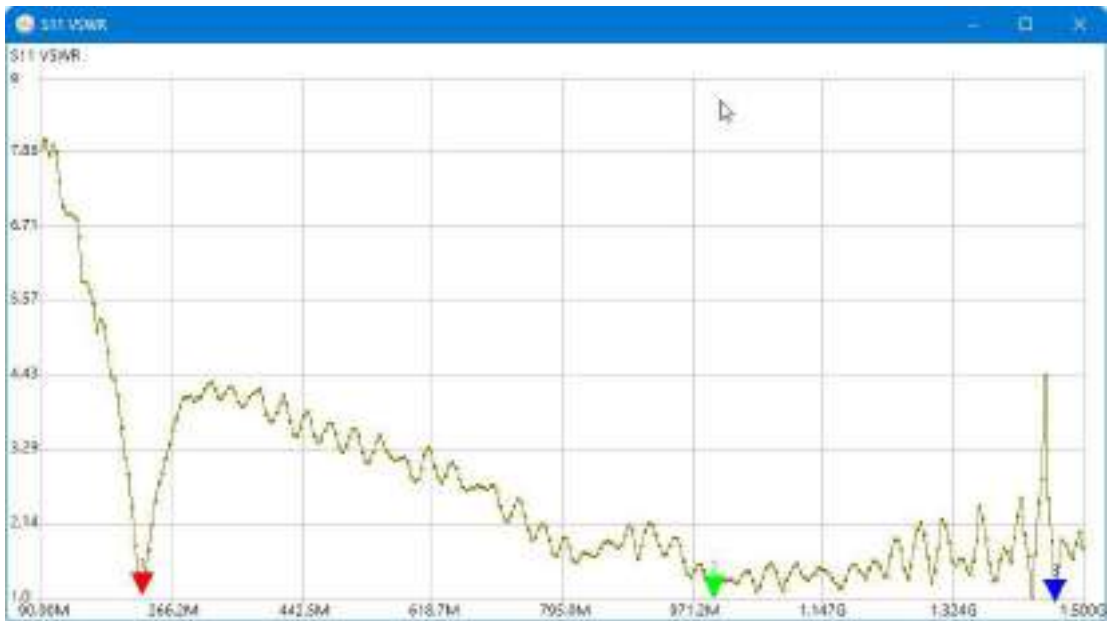
Рис. 40. График КСВ для штатной антенны RTL-SDR Blog V4
