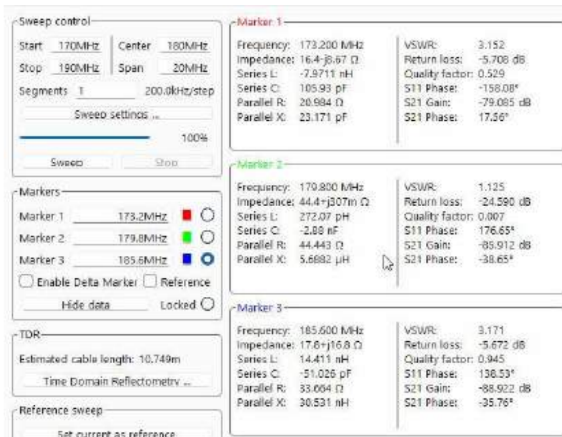
Рис. 43. Результаты тестирования антенны RTL-SDR Blog V4
