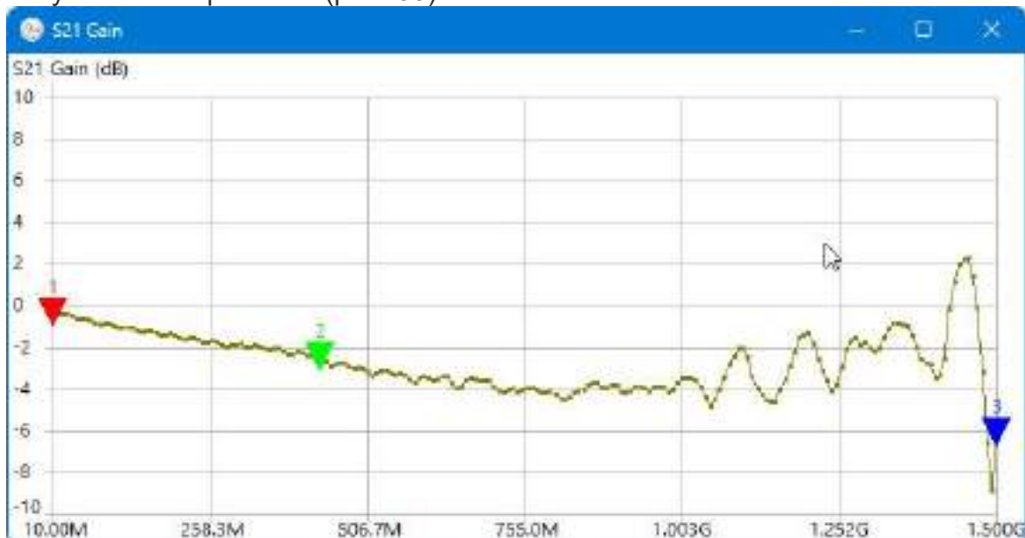
Рис. 60. Потери в кабеле в диапазоне частот от 10 МГц до 1.5 ГГц
