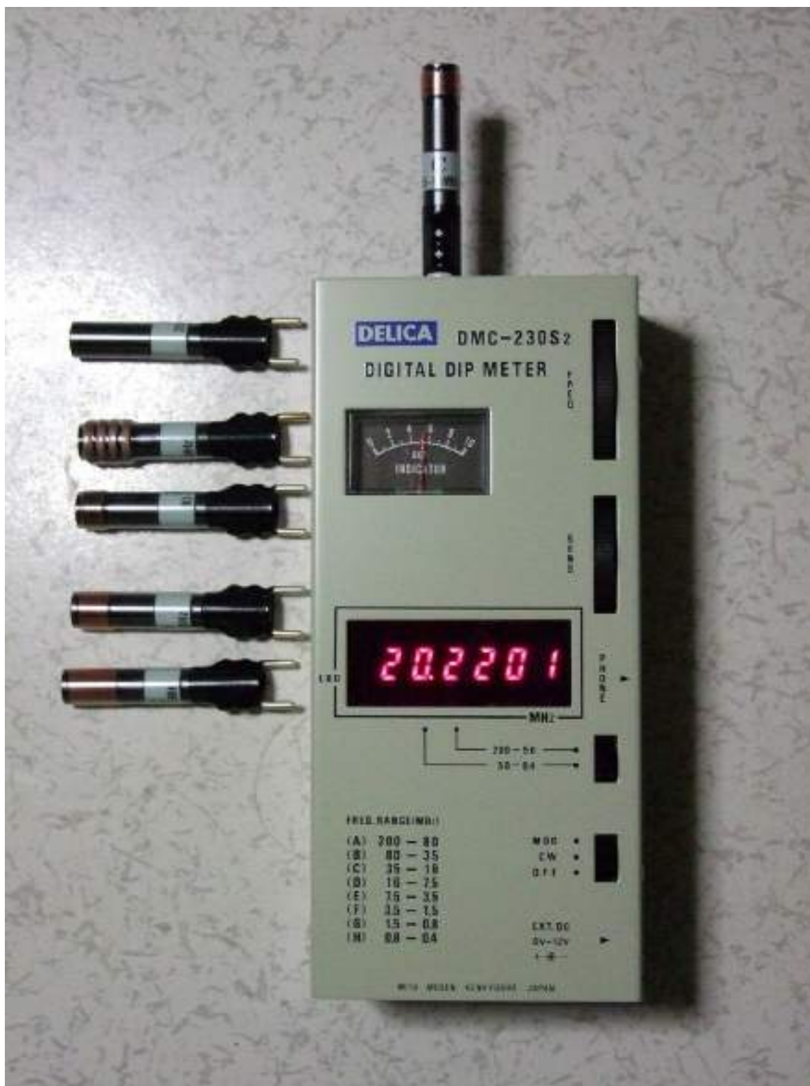
Рис. 52. Современный ГИР с цифровым частотомером и набором сменных катушек (источник)
