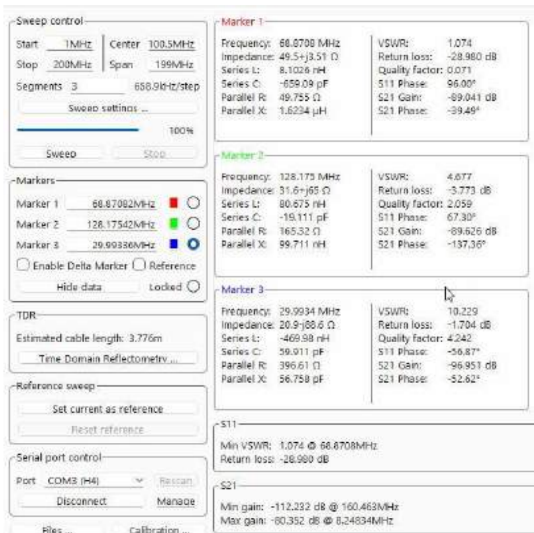
Рис. 39. Параметры полностью раскрытой телескопической антенны
