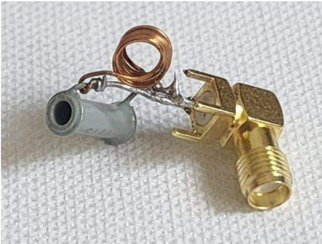
Рис. 47. Колебательный LC-контур для измерения резонансной частоты
