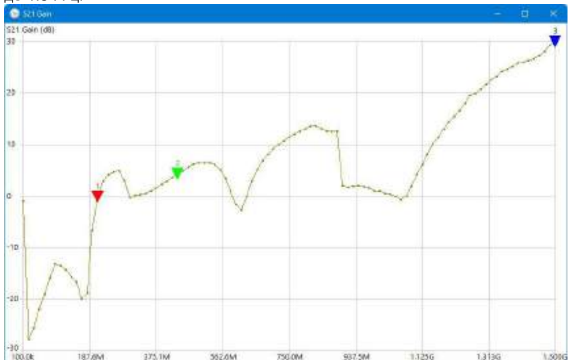
Рис. 31. Диаграмма S21 Gain для тестируемого LNA
