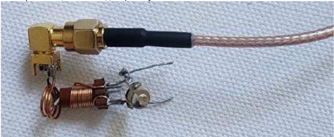
Рис. 54. Измеряем резонансную частоту колебательного контура с помощью ГИР
