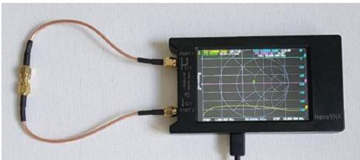
Рис. 12. Калибровка в режиме Thru
